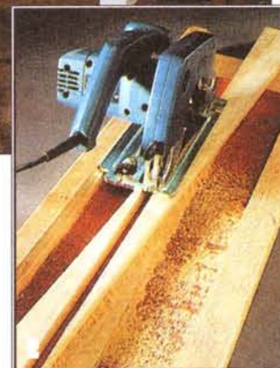
Задние ножки имеют ломаную форму. Их детали в форме клина вырезают дисковой пилой в приспособлении с боковой направляющей, а затем приклеивают клин к противоположной кромке.
