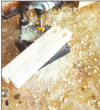
6 В малых брусках на концах просверлил сквозные отверстия под болты.
