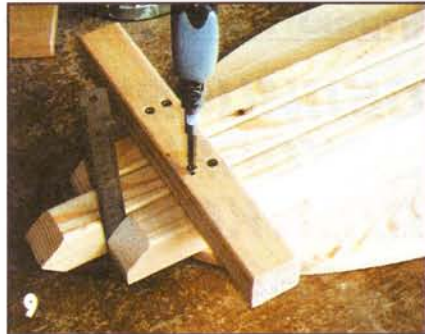
9 Поперечный брусок служит ребром жёсткости и увеличивает площадь опоры.
