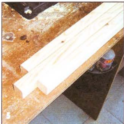
5 После сборки средний опорный брусок развернул на 180°.
