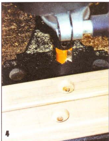
4 Благодаря выборкам головки болтов будут утоплены.
