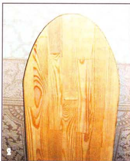
Один край доски скруглил лобзиком.
