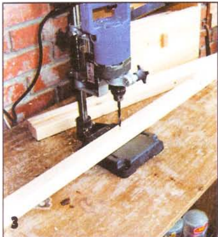
3 После разметки просверлил отверстия в заготовках для ножек.
